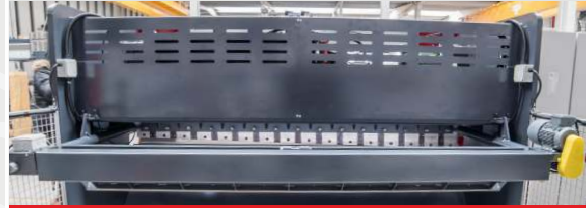
± 0,1mm hassasiyetli motorlu arka dayama
