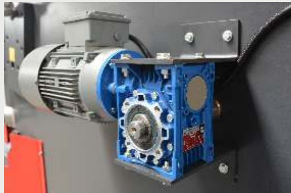
Motorlu Bıçak Boşluk Ayarı (CNC Kontrol Ünitesinden)
