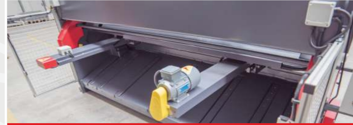
± 0,1mm hassasiyetli motorlu arka dayama
